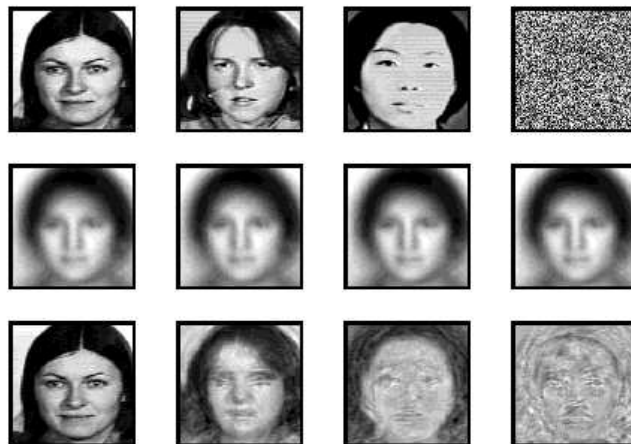
FIG. 2. — Réponses d'un auto-associcateur (entraîné avec des visages caucasiens) à des visages présentés en entrée (1-ère ligne) après apprentissage avec la loi de Hebb (2-ème ligne) et la loi Delta (3-ième ligne). Le premier visage a été appris ( r_H^2 = .71 ; r_D^2 = 1.00 ). Le second visage n'a pas été appris et provient de la même population que les visages appris ( r_H^2 = .66 ; r_D^2 = .85 ). Le troisième visage provient d'une autre population que les visages appris ( r_H^2 = .10 ; r_D^2 = .71 ). La quatrième image se compose de points aléatoires ( r_H^2 = .00 ; r_D^2 = .00 ). r_H^2 , et r_D^2 sont le carré du coefficient de corrélation entre l'image d'origine et sa reconstruction après apprentissage avec la loi de Hebb ou Delta.
